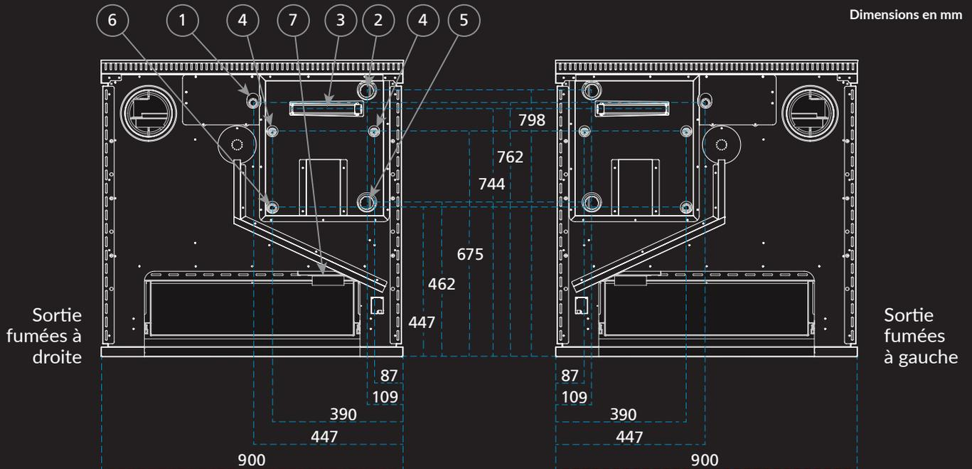
L'espace utile entre les raccords et la paroi arrière d'appui est de 14 mm environ. Éventuellement, il pourrait être nécessaire de prévoir des espaces supérieurs en demandant un dossier supplémentaire pour augmenter la profondeur du plan ou en prévoyant une niche dans le mur au niveau des raccords de chaudière.
