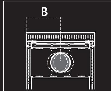
Sur demande, il est possible de commander une plaque supplémentaire permettant de couvrir un intervalle intermédiaire pour la sortie fumées par l'arrière. La position de base (X) doit être définie lors de la commande. L'amplitude de la plaque permet une variation de la position horizontale de  $\pm 20$  mm.
