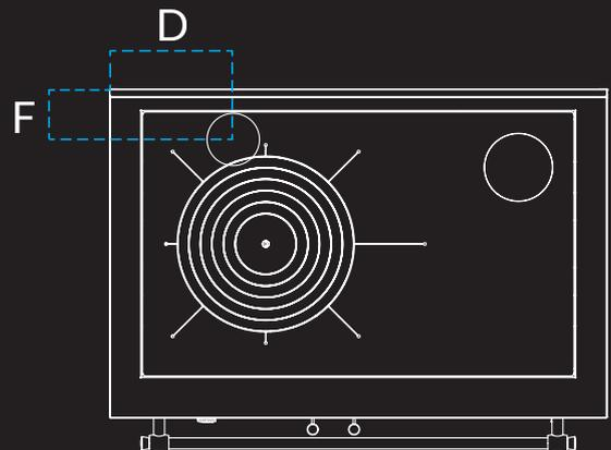
\* La version avec sortie fumées à gauche est symétrique. La prise d'air est toujours positionnée sous la chambre de combustion.
