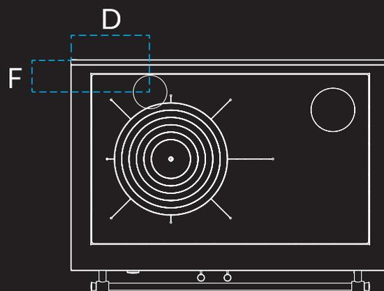
\* Herde mit Rauchausgang links sind symmetrisch. Die externe Frischluftzufuhr befindet sich immer auf der Seite der Brennkammer.
