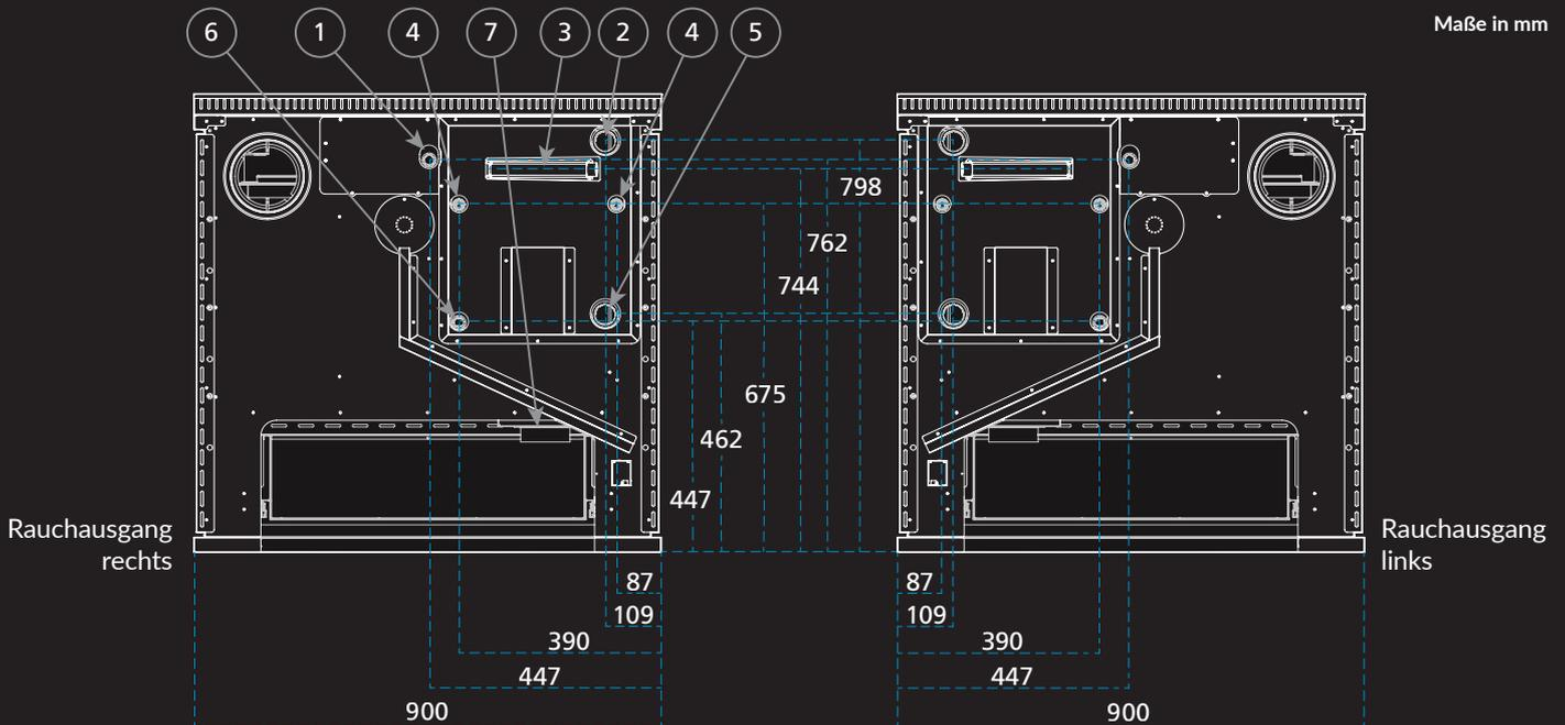
Der zur Verfügung stehende Zwischenraum zwischen Anschlüssen und der Wand des Aufstellraums beträgt ca. 14 mm. Bei Bedarf könnte es notwendig sein, einen größeren Zwischenraum in der Tiefe durch eine zusätzliche Wischleiste oder mit einer Nische in der Wand zu schaffen.
