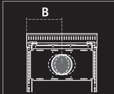
Auf Anfrage ist es möglich, eine zusätzliche Anschlussplatte für den Rauchausgang hinten, in den mittleren Positionen, zu bestellen. Bei Bestellung dieser Platte muss die Rauchausgangsmitte (X) angegeben werden. Diese Anschlussplatte ermöglicht horizontal einen Spielraum von  $\pm 20$  mm.
