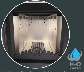
L'innovativo sistema di combustione H<sub>2</sub>O System® è caratterizzato da una camera di combustione interamente rivestita con delle protezioni in acciaio, che permettono di creare un'intercapedine tra il corpo caldaia e le protezioni per il passaggio dell'aria secondaria per una maggiore efficienza. Inoltre il fuoco non è più a contatto diretto con le pareti della caldaia.
