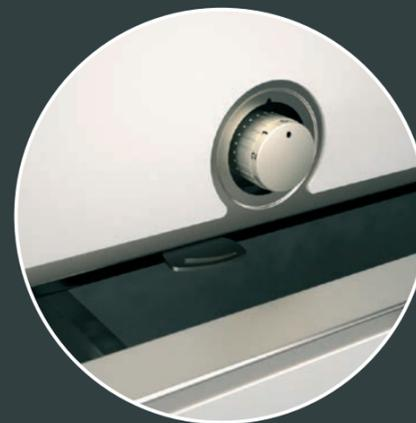
Il regolatore automatico di tiraggio integrato permette di ottimizzare l'afflusso di aria durante la combustione, di ridurre notevolmente il consumo di legna ed una diminuzione dei valori di emissione. In combinazione al regolatore di tiraggio è previsto un comando per la regolazione/chiusura della presa d'aria esterna.
