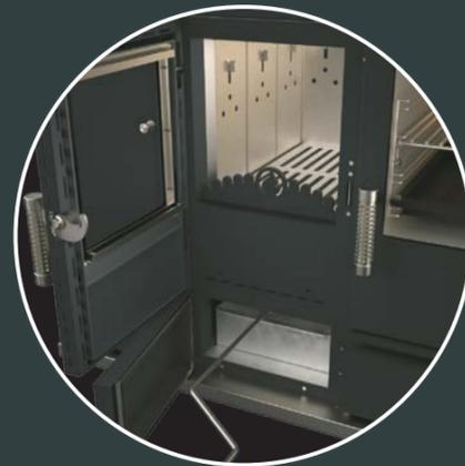
Il sistema di regolazione della griglia fuoco permette di variare la capienza della camera di combustione e anche il rapporto tra la potenza ceduta alla caldaia e quella alla piastra. La posizione bassa è ideale per il riscaldamento e per una maggiore autonomia, la posizione alta è più indicata per la cottura dei cibi.
