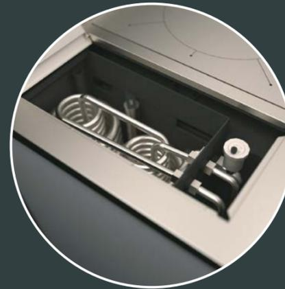
All'interno della caldaia sono presenti due serpentine in acciaio inox che garantiscono un ottimo scambio termico. Le serpentine fanno parte di due circuiti separati, uno per l'impianto di riscaldamento e l'altro per la produzione di acqua calda sanitaria istantanea. A fianco, la valvola di sfogo automatica che facilita l'installazione e l'uso dell'apparecchio.
