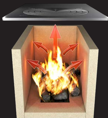
Fase 1: Accumulo e rilascio del calore nella camera di combustione in materiale refrattario durante la combustione
