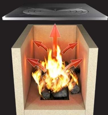
Fase 1: Accumulo e rilascio del calore nella camera di combustione in materiale refrattario durante la combustione
