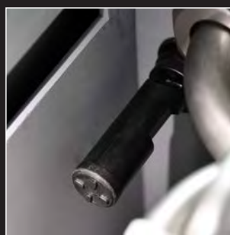
Livellostato per il controllo del livello dell'acqua nella caldaia
