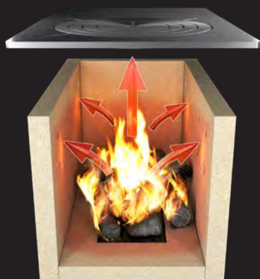
Fase 1: Accumulo e rilascio del calore durante la combustione
