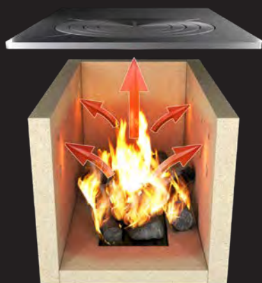
Phase 1: Accumulation et restitution de la chaleur pendant la combustion
