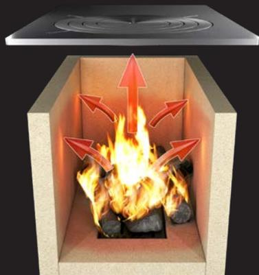
Fase 1: Acumulación y liberación de calor en la cámara de combustión refractaria durante la combustión.
