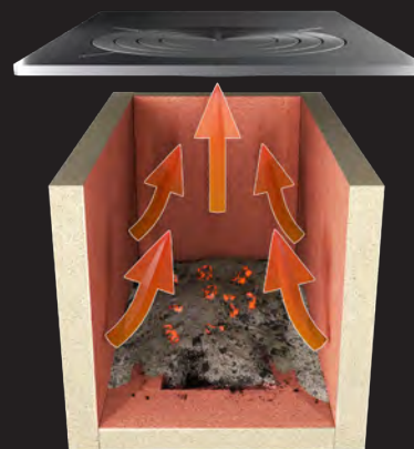
Phase 2: Konstante und allmähliche Freisetzung von Wärme, auch wenn das Feuer bereits erloschen ist
