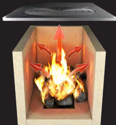
Phase 1: Wärmespeicherung und -abgabe während der Verbrennung
